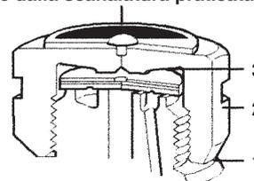
Le versioni TD 32FA e TD 32FALC sono equipaggiate con l'otturatore a disco antibloccaggio da aria
